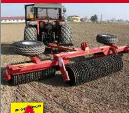
Rullo costipatore con dischi flottanti dentati in ghisa Ø 530/600mm, con cilindro ed impianto elettrico. Assicurano una compattazione ideale del terreno senza ondulate grazie ai diametri grandi dei dischi, donando un buon contatto tra terreno e semente/radice ed inoltre riducendo sensibilmente la porosità del terreno, evitando quindi un'eccessiva evaporazione dell'acqua in caso di siccità.
