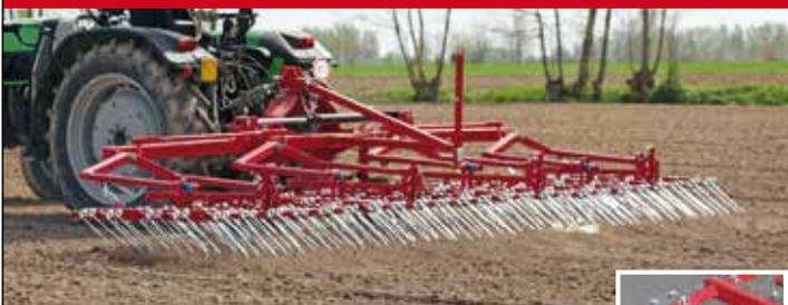
Con questo modello aumenta di vitalità il suolo, si può ottenere l'effetto desiderato per i molteplici lavori che può fare. Ideale per la aerazione e la fertilizzazione ed al miglioramento del suolo, mantiene le erbacce sotto controllo. 4 settori operanti, 5 file di denti e 120 denti doppi a molla, trattore consigli : 60/70 CV, 650 Kg.
