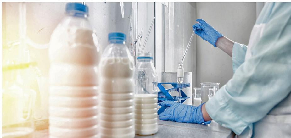
**La determinazione del parametro analitico del punto di congelamento del latte, o indice crioscopico, permette di verificare, fra gli altri, problemi in stalla o nell'impianto di mungitura legati a quantitativi di acqua che accidentalmente possono confluire nel tank**
