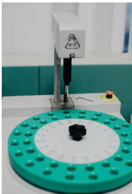
**Il crioscopio, strumento utilizzato per la determinazione del punto di congelamento del latte**
